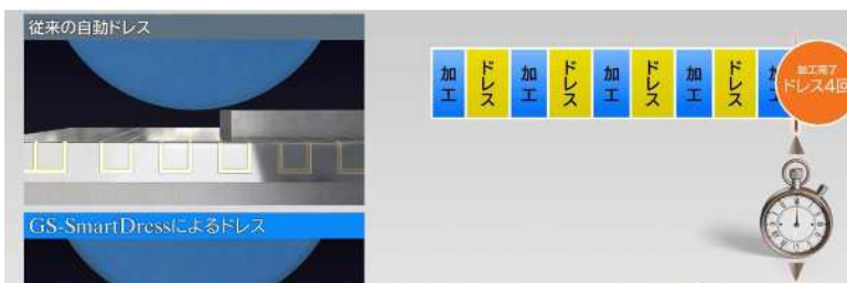
図3 新旧ドレス機能の加工時間比較 ※社内テストデータを基にした概念図
