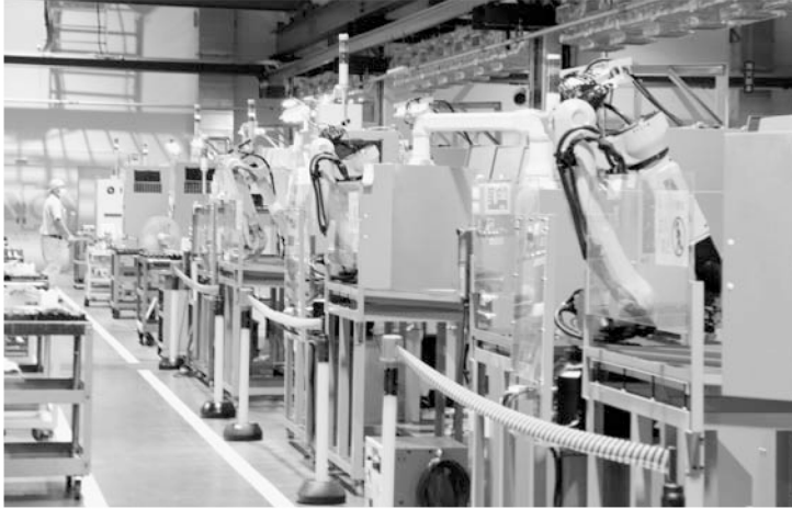
かずさアカデミア工場のネジ研削盤（産業用ロボットも搭載する）
