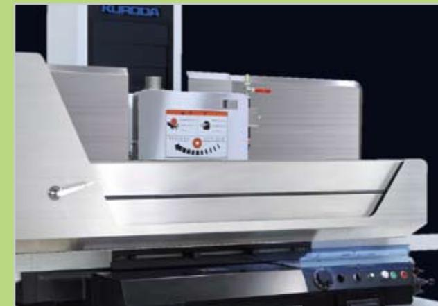
作業性の良い折りたたみ式ステンレス製フロントカバー。
