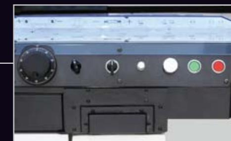
サドルに配置して作業性の良くなった前後送りハンドル、左右送リコントローラー、マグネットチャックコントローラー。ワークから目を離さずに、手元での作業が出来ます。
