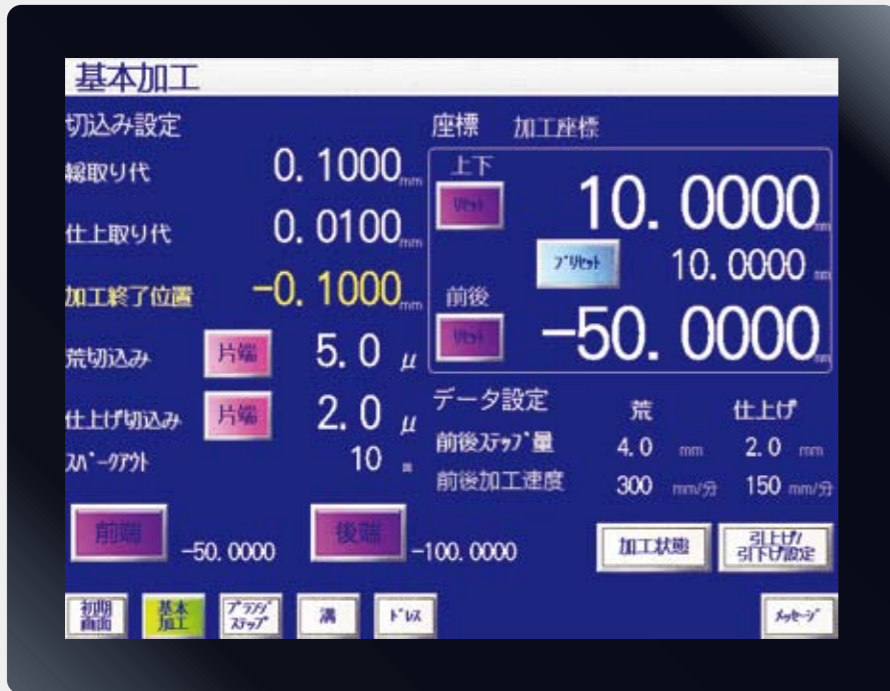
基本加工 平面加工時に使用する画面です。 Basic in-feeding setting screen The screen is applied for surface grinding
