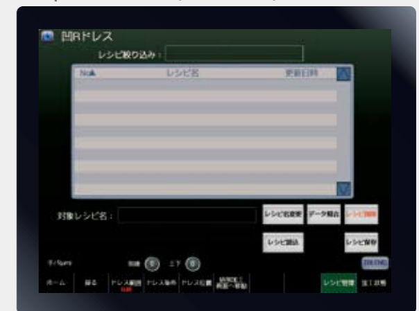
レシピ機能 加工やドレス条件を保存・読み出します。 Recipe Grinding data and dressing data can be saved screen.
