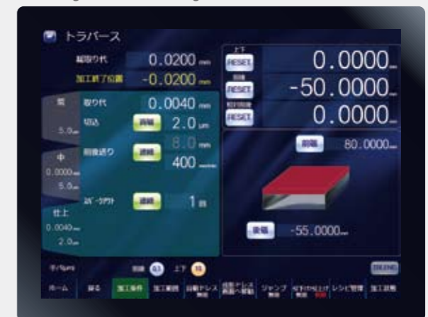
レシピ機能 加工やドレス条件を保存・読み出します。 Recipe Grinding data and dressing data can be saved screen.
