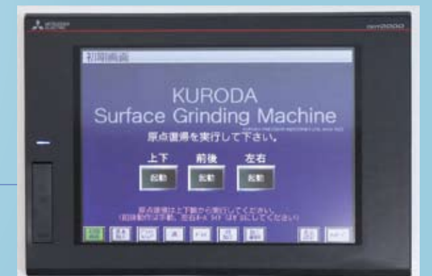
直感的な操作を可能にした10.4 inch対話型 タッチパネル画面(オプション GS-SmartTouch: 15inch) 10.4inch interactive touch panel enables intuitive operation (Option GS-SmartTouch: 15inch).
