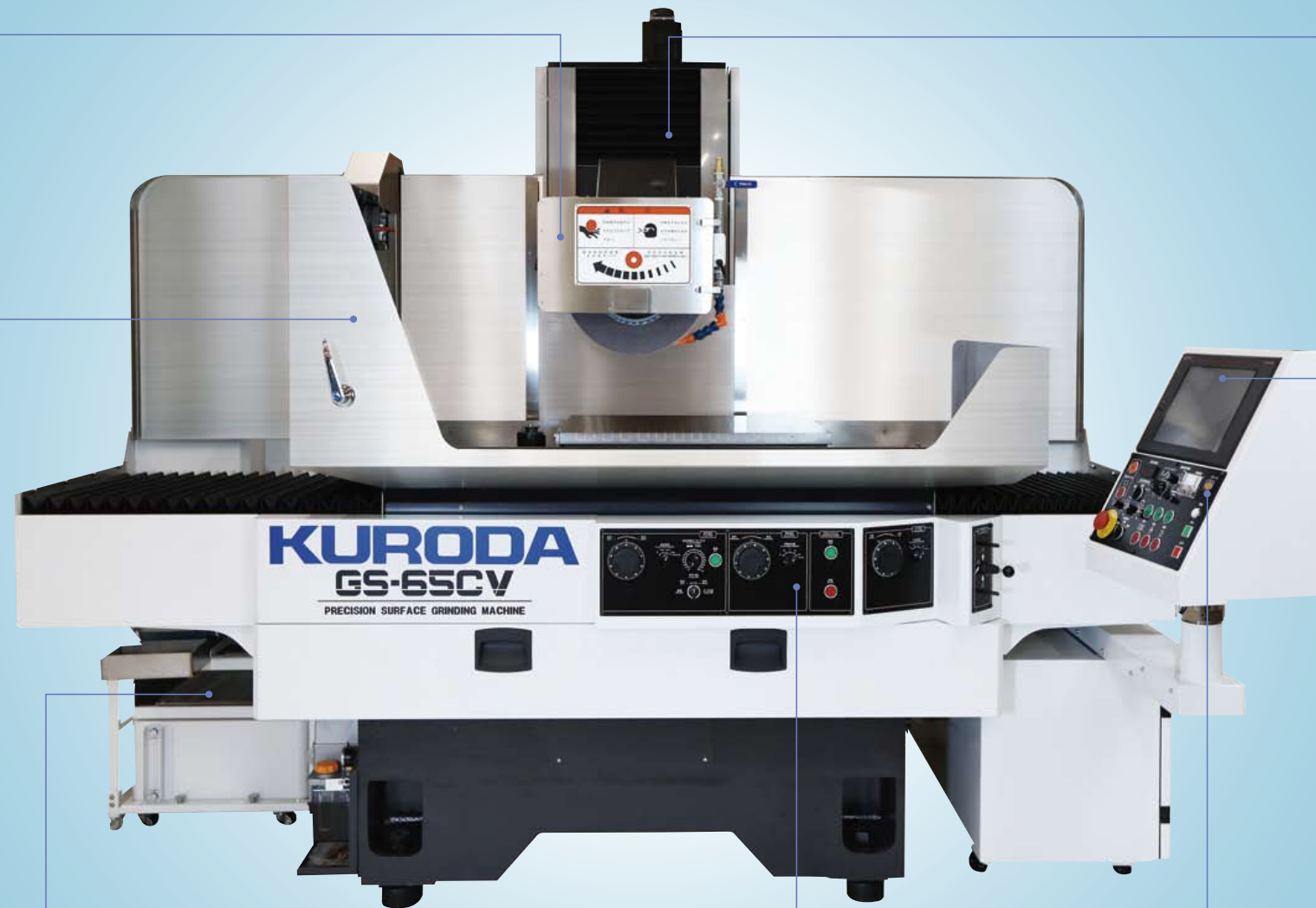
PHOTO : GS-65CV (標準オープンカバータイプ) オプションにより仕様は変わります。 GS-65CV (Standard open cover type) the specification will be changed according to option.
