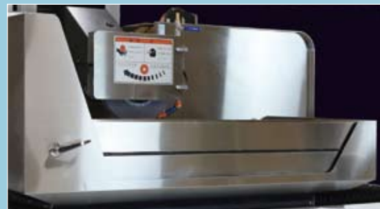
安全に作業・確認ができるステンレスカバー Safety machining can be available by a stainless steel cover.
