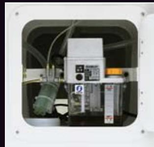
室温に同調した新しい潤滑油を摺動面へ供給する独立常温集中潤滑ポンプ
