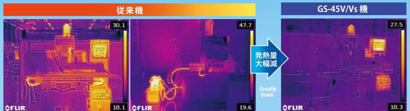
従来の油圧機では上の測定結果のように温度が上昇し加工精度や周囲への
