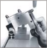
縦のダイヤ60°横のダイヤ30°に成形
