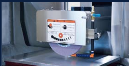
耐食性に優れたステンレス製湿式カバー Corrosion-proof stainless steel splash guard cover
