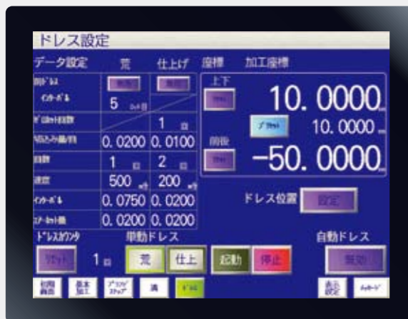
自動ドレス条件設定画面 自動ドレス条件を荒/仕上げ加工別に設定します。 Setting the dressing conditions for Rough and Finish Rough and Finish dressing can be set separately.
