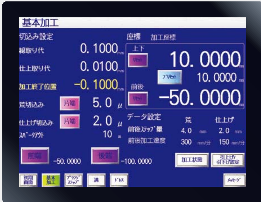
自動ドレス条件設定画面 自動ドレス条件を荒/仕上げ加工別に設定します。 Setting the dressing conditions for Rough and Finish Rough and Finish dressing can be set separately.
