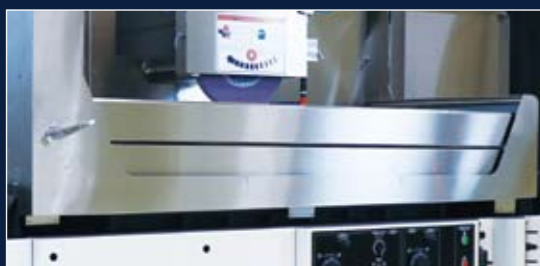
安全に作業・確認ができるステンレスカバー Safety machining can be available by a stainless steel cover.
