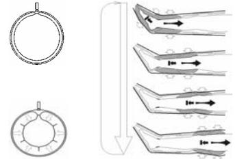
◇単一故障により異常な高圧が発生しても、リリース弁(非常用排気弁)が作動し、スリーブには26.7kPa以上の圧力がかからない様になっている。
