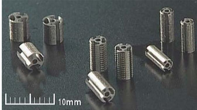
LASER FASTEC技术是为了高精度小型薄板积层品量产研制开发的技术。薄板积层固定采用激光，以此解决了产品形状受限的制约，实现以前加工难的微型薄板积层品的量产化。
