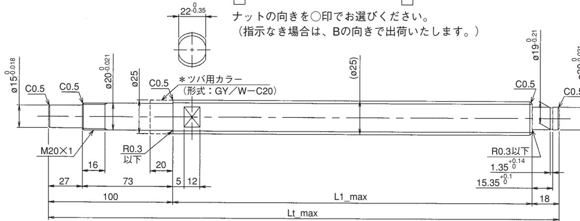
※下表の▲印付きサイズは、固定側および支持側端末径φ20部にスパイラルマークの残る場合があります。
