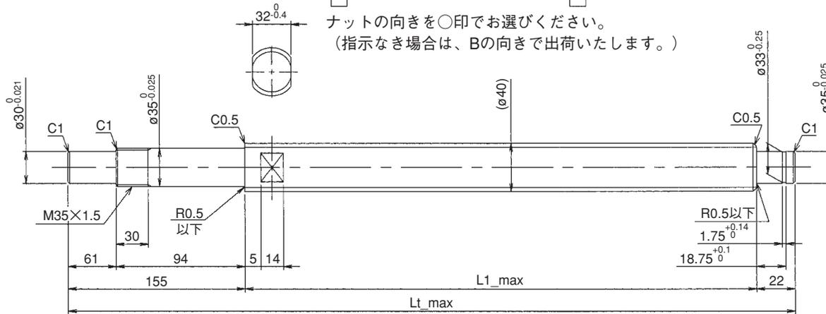
※下表の▲印付きサイズは、固定側および支持側端末径φ35部にスパイラルマークの残る場合があります。
