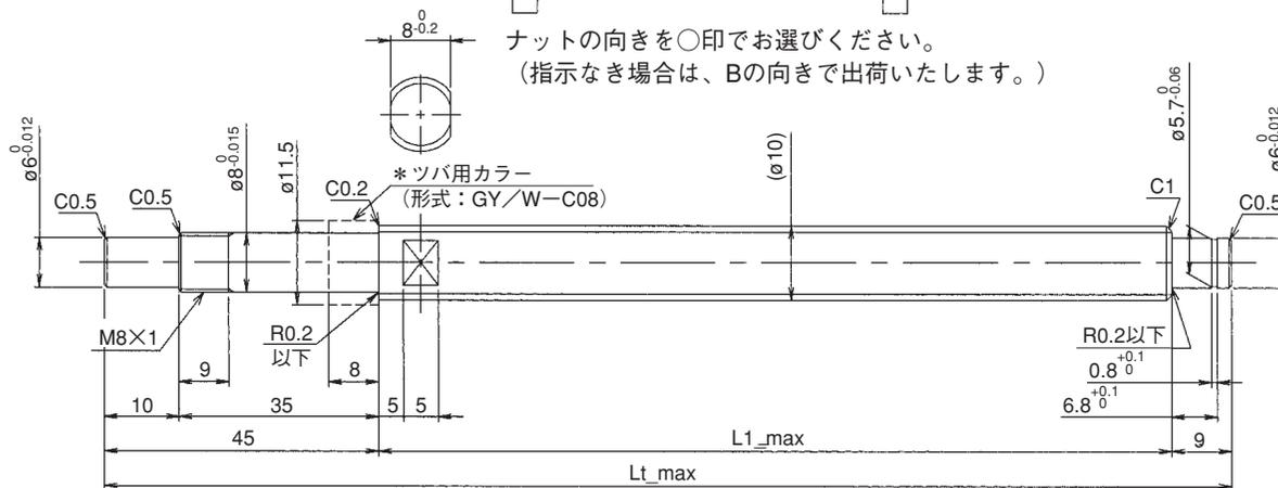
※下表の▲印付きサイズは、固定側端末径φ8部にスパイラルマークの残る場合があります。
