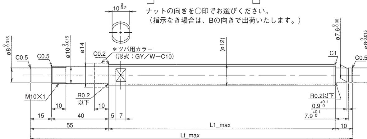
※下表の▲印付きサイズは、固定側端末径φ10部にスパイラルマークの残る場合があります。
